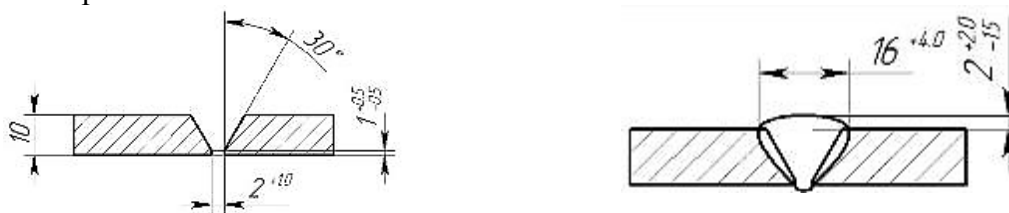
Рисунок 1 - Геометрические параметры соединения типа С17 по ГОСТ 16037-80
