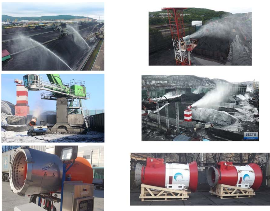
Рисунок 2 – Системы пылеподавления и орошения в портах Дальнего Востока
