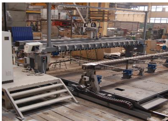
Рисунок 1 – Внешний вид автоматической аргонодуговой установки УСП-5000
