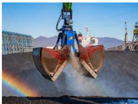
Рисунок 6 – Грейфер с встроенной системой пылеподавления ОАО «Терминал Астафьева», расположенный в порту Находка, использует закрытую линию для перевалки угля, а также строит навес над зоной выгрузки.
