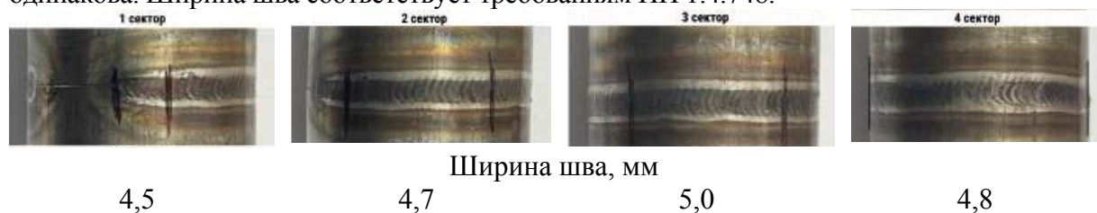
Рисунок 1 – Внешний вид полученного сварного соединения
